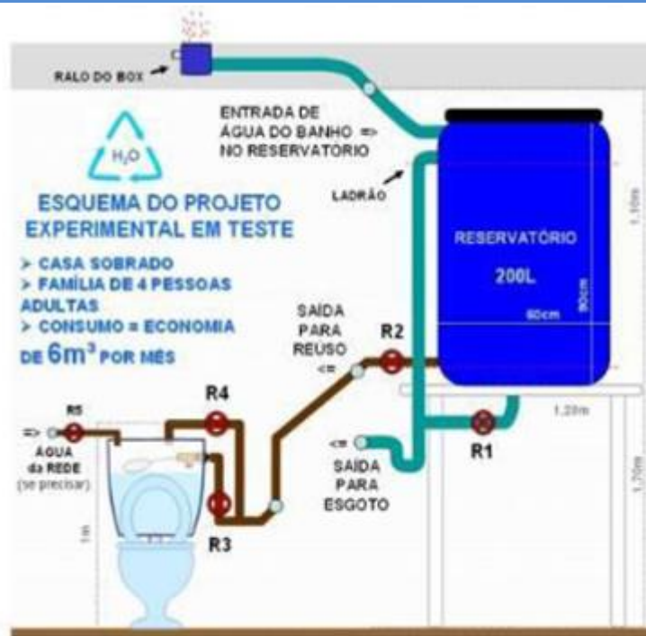
Figura 20: Esquema simplificado de reuso de efluente Fonte: Sociedade do Sol, 2013
