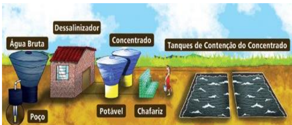
Figura 16: Sistema de dessalinização de águas subterrâneas Fonte: Ministério do Meio Ambiente, 2015
